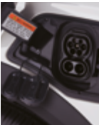
Conector de carga tipo 2 (Mennekes) y conector CCS
